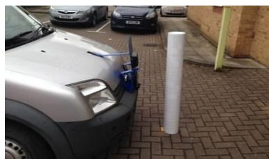
mastro longo de 1m na frente de uma câmera montada em 0,6m
